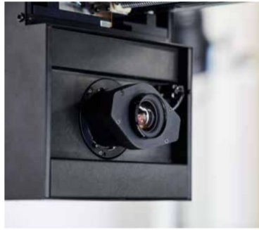
teljesen új fejlesztésű kamerarendszer, mely CMOS érzékelőn alapul
